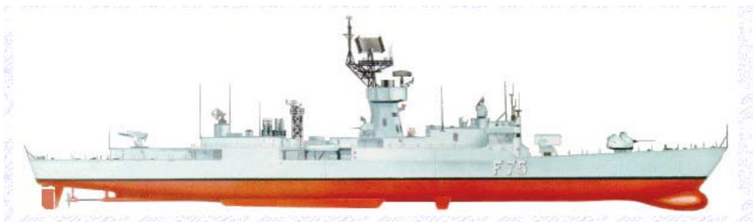
Figura XIV.1.5: El ángulo de ataque se mejora con un "Bulbo de roda"...
