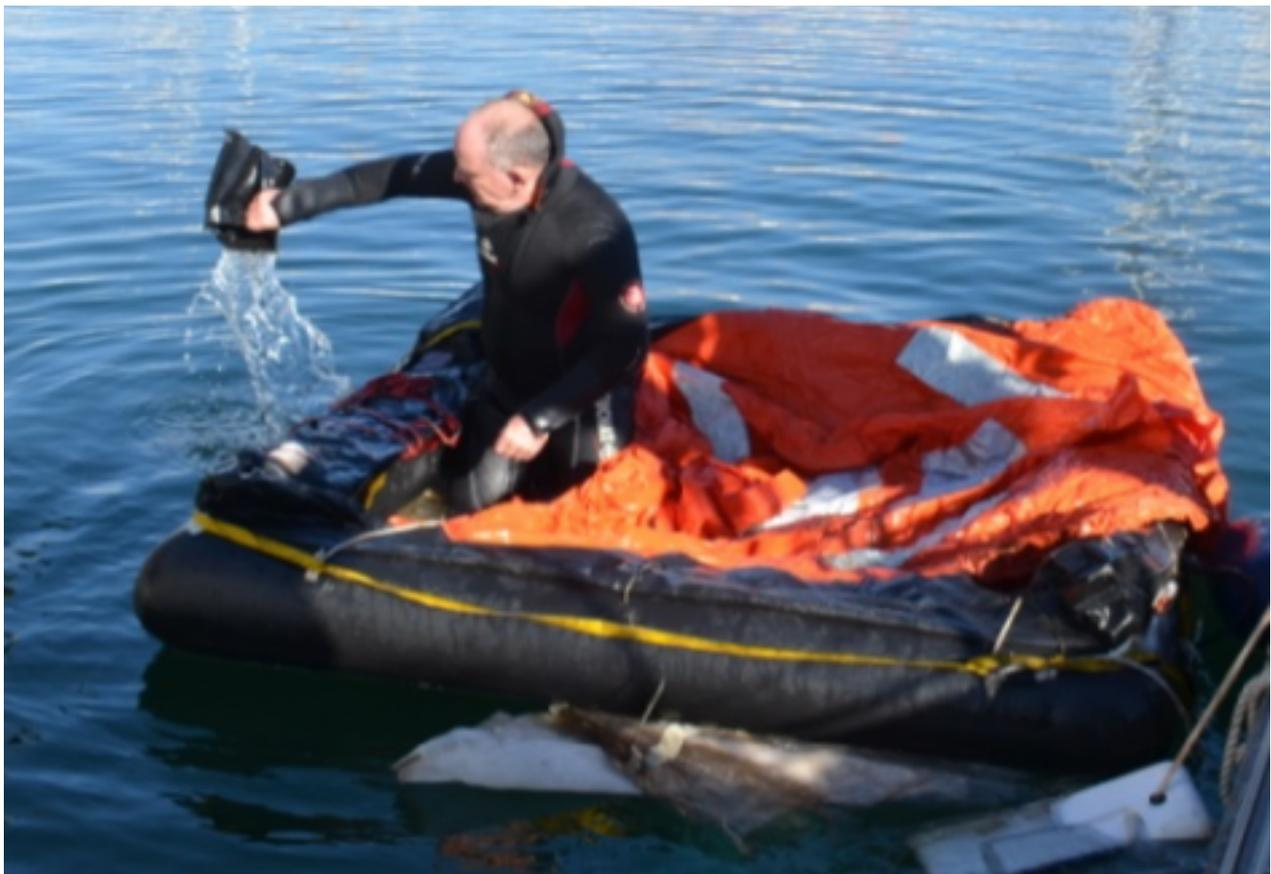
Remarquez, au bas de l'image l'état de l'enveloppe étanche : sale et boueuse. La pression des boudins n'est pas au top. Sans étanchéité , les bouteilles et raccords ont aussi souffert
