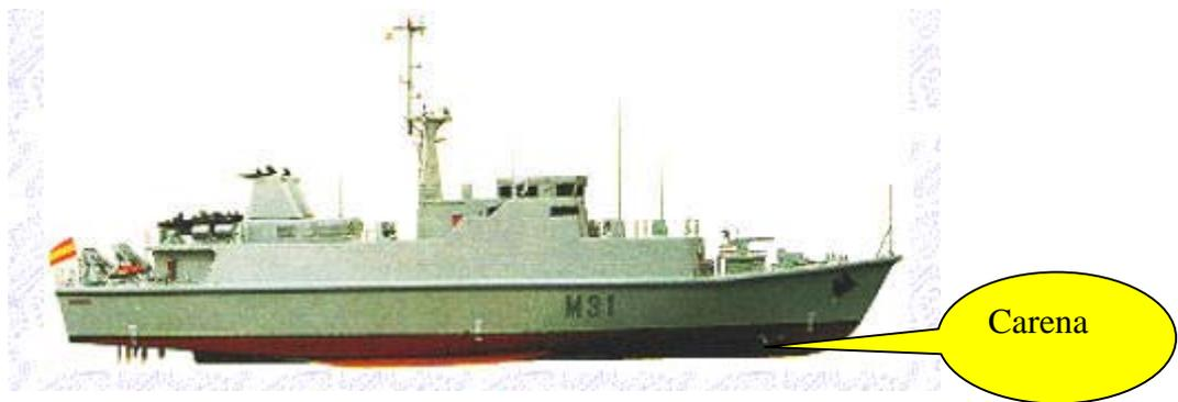
Figura I.1.4: La carena de un buque es su parte sumergida...
