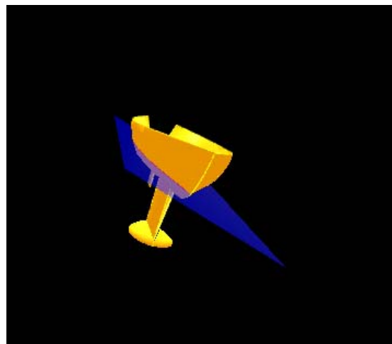
Figura 628.1.2: A la izquierda, waterline con "escora" cero; a la derecha con "escora" de 15º....
